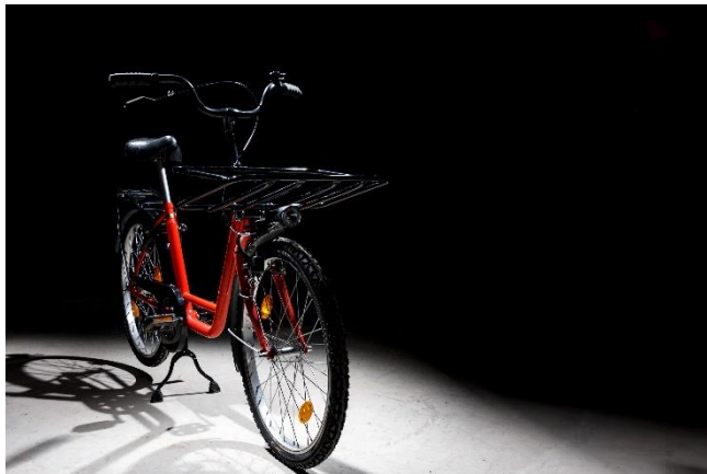
Beispiel mit Lastträger vorne und Zweibeinständer (Bei Montage eines Lastträgers wird die standardmäßig montierte Alu-Seitenstütze durch einen Stahl-Zweibeinständer ersetzt)
