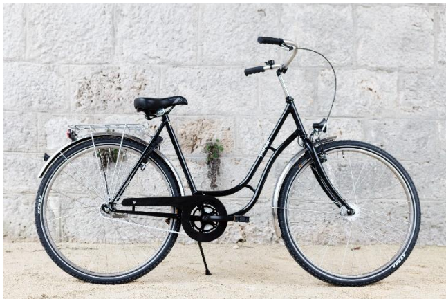
Beispiel Damenrahmen mit Ventura-Sattel, Nabendynamo sowie Schutzblechen, Felgen und Speichen aus Niro-Stahl
